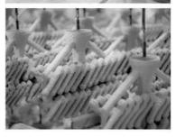
خوشههای مهوم در فاصلههای زمانهی مناسب به داخل دوغابهای سرامیکی مختلف فرو برده می شوند تا پوسته سرامیکی تشکیل شود. در نهایت، بعد از خشک شدن پوسته سرامیکی موم قطعه توسط اتوکلاو خارج و قالب سرامیکی آماده میشود.
