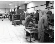
به منظـور ریخته گری هر قطعه، تولید نمونه مومی ضروری می باشد. مدلهای مومی با استفاده از دستگاه های تزریق موم به داخل قالب های فلزی که عمـدتا از آلیـاژهای فـولادی و آلومینیومی ساخته شده اند، تزریق میشوند.
