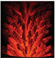
بعد از اتمـام فرآیند انجماد و سـرد شدن قطعات، سرامیکها شکسته شده و پـس از برشکاری قطعات از راهگاه و پاکسازی کامل آنهـا توسط دستگاه شاتبلاست یا بازرسـی نهـایی و عملیات حرارتی مورد نیـاز آماده می شوند. برای خارج سازی ماهیچههای سرامیکی از داخل قطعات از فرآینـد لیچینگ در محلـول شیمیایی استفاده میگردد.
